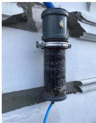
Abbildung 13: Minifilter für Probeflächen 1 und 3 der Fassadenuntersuchungen in Münster (siehe Kapitel 2) (links); Konzentrationsverlauf für Terbutryn im Fassadenabfluss mit und ohne Filter (rechts).
