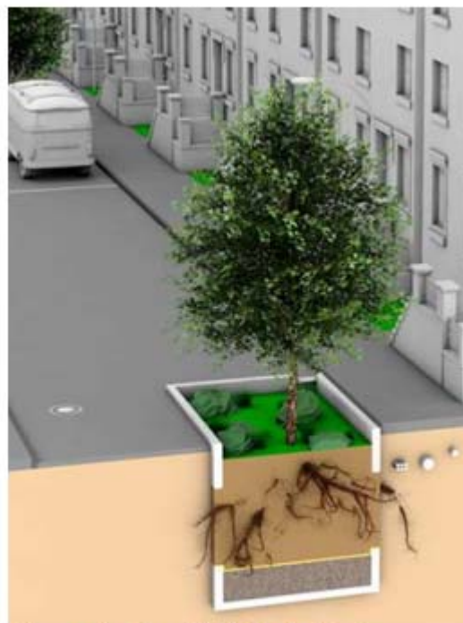
Schema einer Baum-Rigole (Quelle: Sieker)
