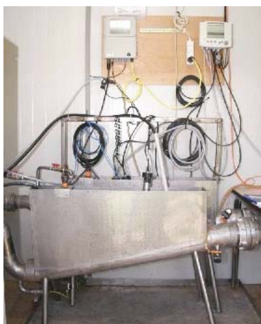
Abbildung 2.5: Links: Foto Messgerinne für Kanal und Entlastung. Rechts: Probenahmestelle Entlastung RÜB. Beide aus Graner et al. (2007)
