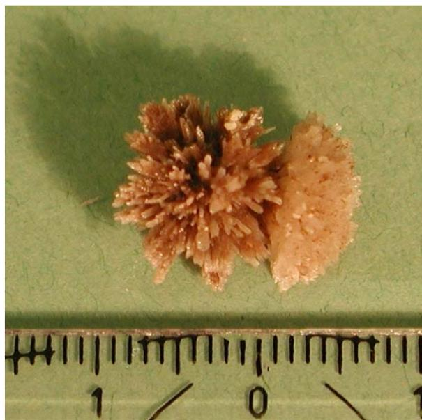
**Picture 12:** Potassium Ammonium Phosphat ( $0.73 \text{NH}_4\text{H}_2\text{PO}_4 \cdot 0.27 \text{KH}_2\text{PO}_4$ )
