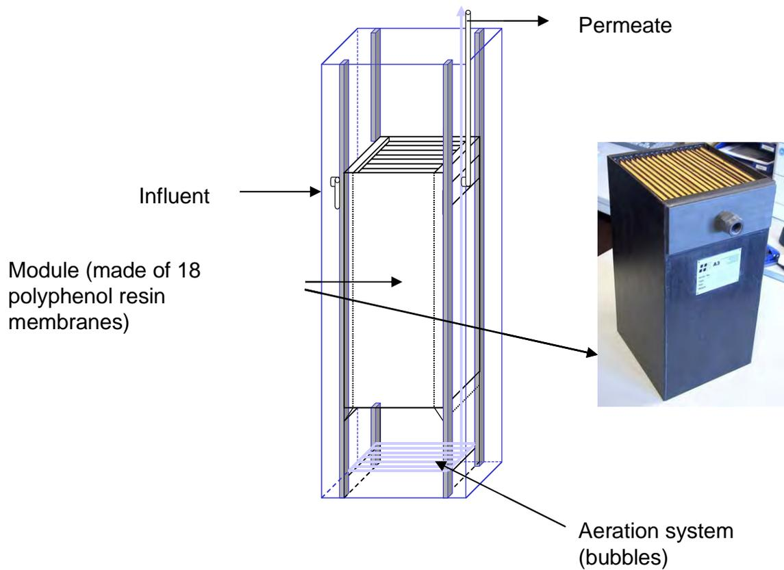
**Fig. 2.4.7:** Membrane bio-reactor module
