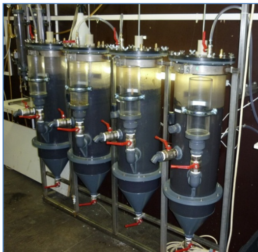
Abbildung 2: Vergärungsreaktoren im Labormaßstab (40L) für Pilotversuche und Geräte für die thermische Hydrolyse
