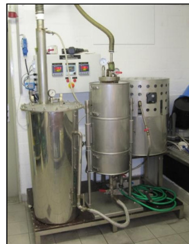
Abbildung 2: Vergärungsreaktoren im Labormaßstab (40L) für Pilotversuche und Geräte für die thermische Hydrolyse
