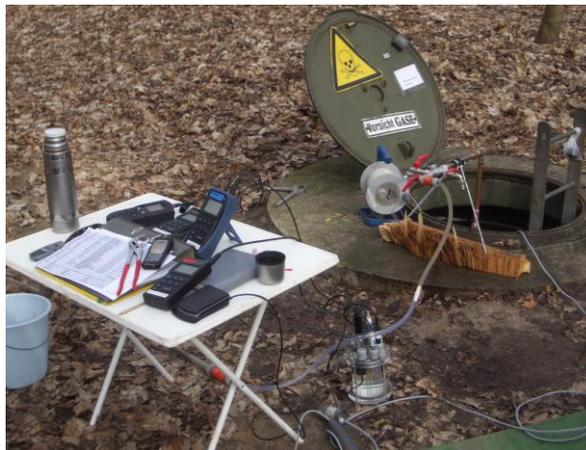
Fig. 3: Messungen und Probenahme während des Kurzzeitmonitorings der mikrobiologischen und hydrochemischen Parameter [FUB 2008]
