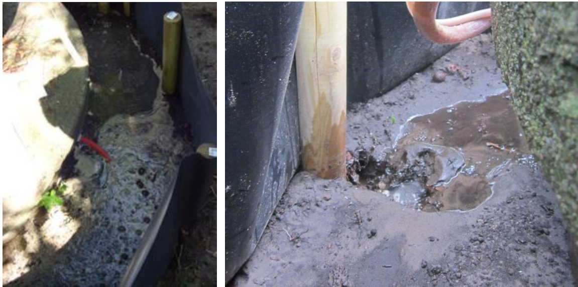
Abbildung 9: Einstellung der Überstauhöhe im Ringinfiltrometer (links) und bevorzugte Wegsamkeit während der Infiltration über Tiergänge auf der Infiltrationsfläche (rechts).
