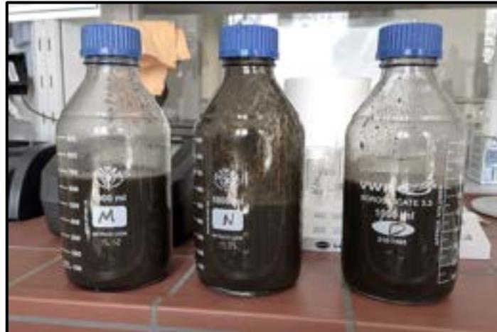
Bild 54: Schlammproben aus dem Membran-, Nitrifikations- und Denitrifikationstank für die TS-Messung
