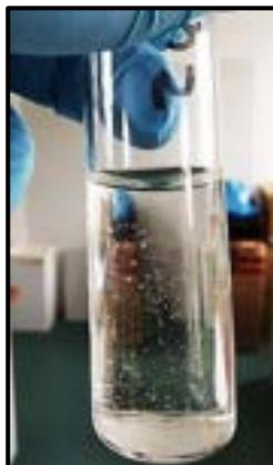
Bild 58: Flocken in der filtrierte Zulaufprobe (nach Filtrax)
