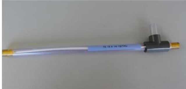
**Abbildung 20:** Einzelfaser-Modul, hergestellt von inge, für Beschichtungs- und Filtrationsversuche im Labormaßstab
