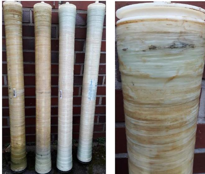
**Abbildung 52** links – ausgebaute Membranmodule (links Modul 1) kurz nach Versuchsende; rechts – Nahaufnahme Modul 1 mit schleimigen Ablagerungen und bräunlichen Verfärbungen
