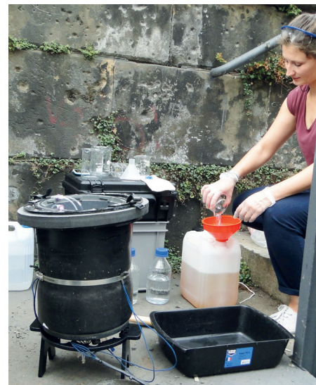
Bild 4a+b Echtzeit-Überwachung von Hygieneparametern in Badegewässern mit dem Sensor ALERT der Firma Fluidion: Vorbereitung und Fernüberwachung des Sensors zur Messung von E. coli und Enterokokken beim Einsatz in der Berliner Stadtspre.
